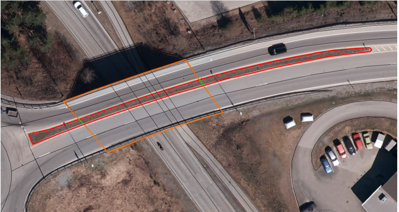
Figur 8. Eksempel på registrering av trafikkøy som delvis ligger på bru. Her er det benyttet VegFiktivGrense (grønn stiplet) for å avgrense delen av trafikkøya som ligger oppe på brua (MEDIUM L).
