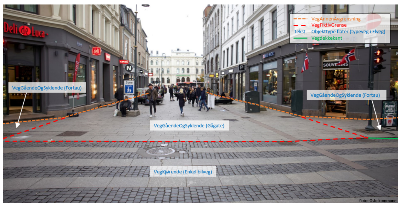
Figur 30. Eksempel på registrering av objekttype VegAnnenAvgrensning i forbindelse med gågate
