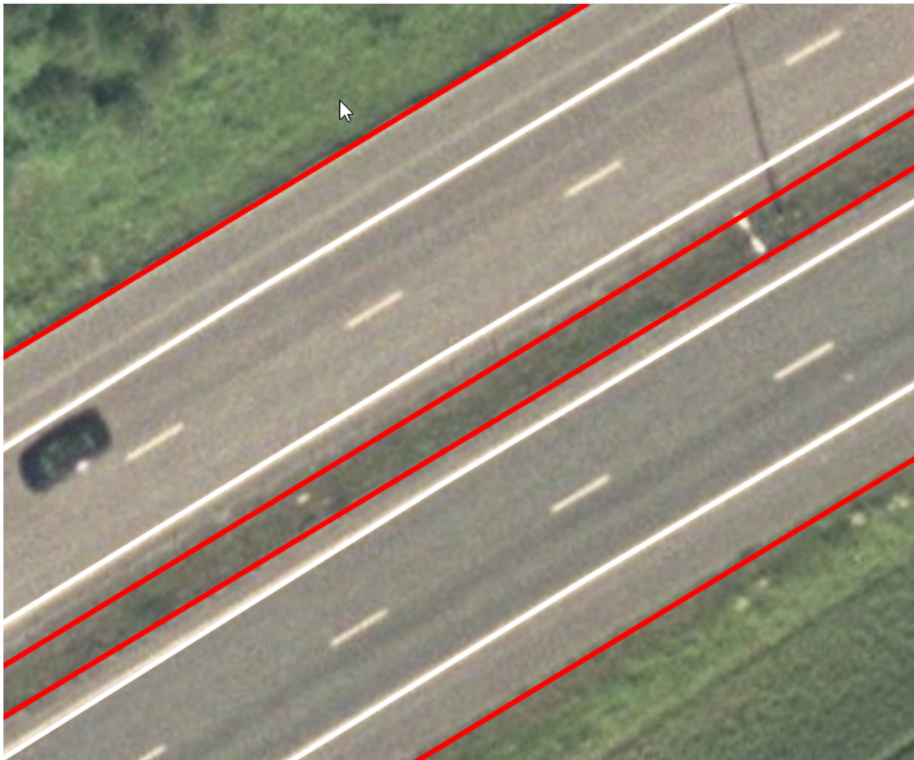
Figur 67. Eksempel på registrering av objekttype Vegskulderkant for motorveg (rød strek). Her skal planumskanten registreres.
