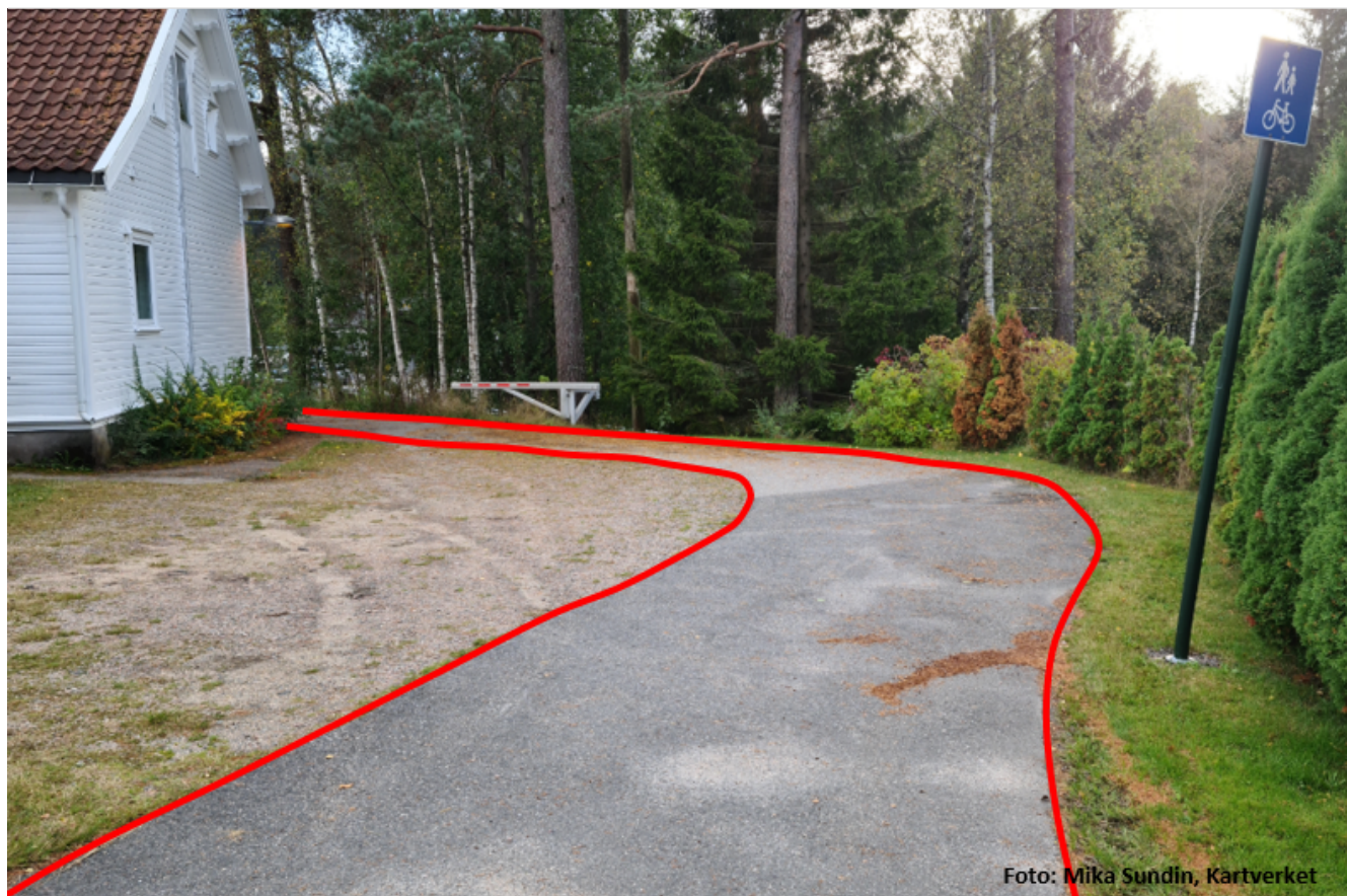
Figur 34. Eksempel på registrering av gang- og sykkelveger med Vegdekkekant (tegnet med rød strek)
