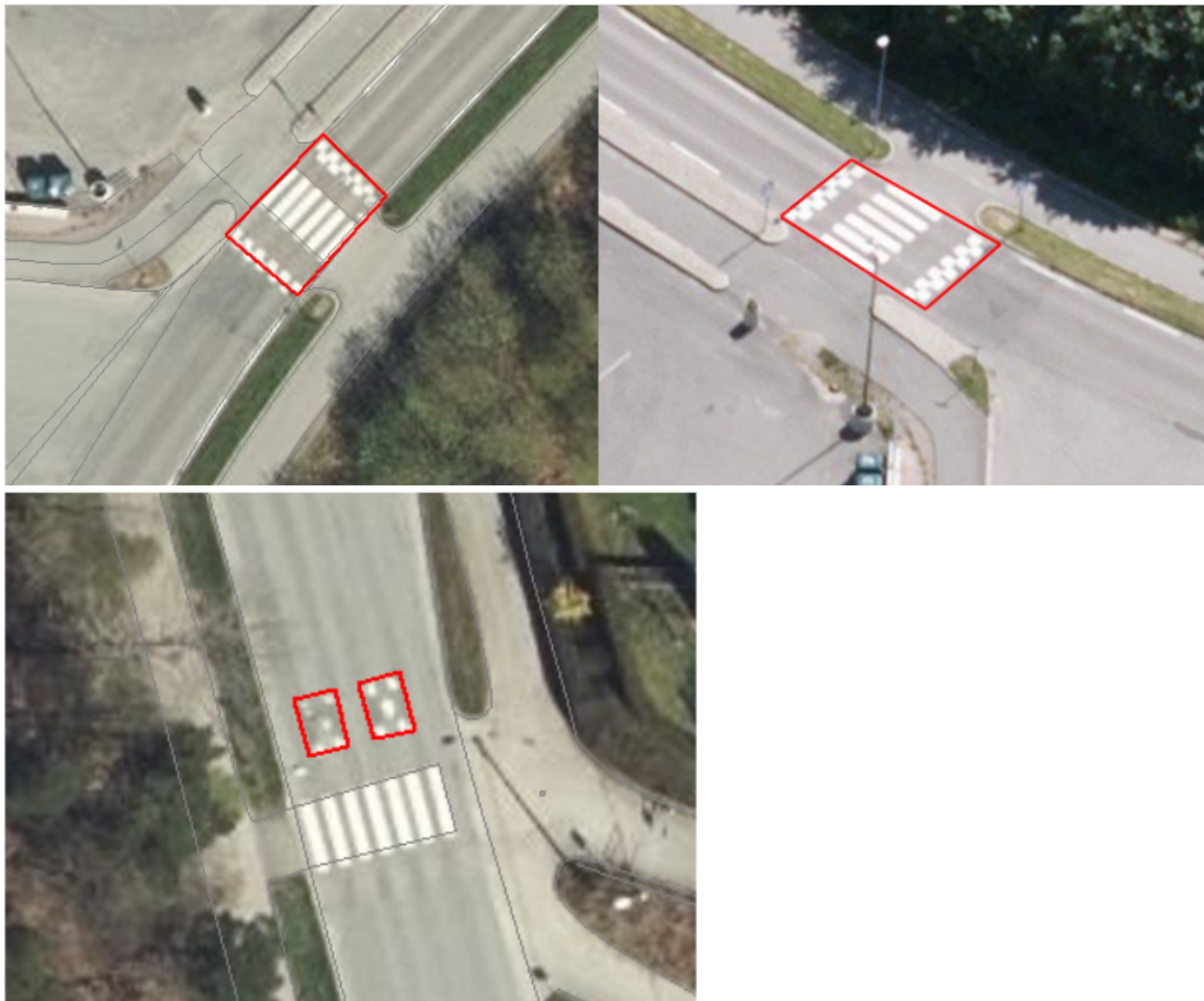
Figur 48. Eksempel på registrering av FartsdemperAvgrensning (tegnet med røde streker)
