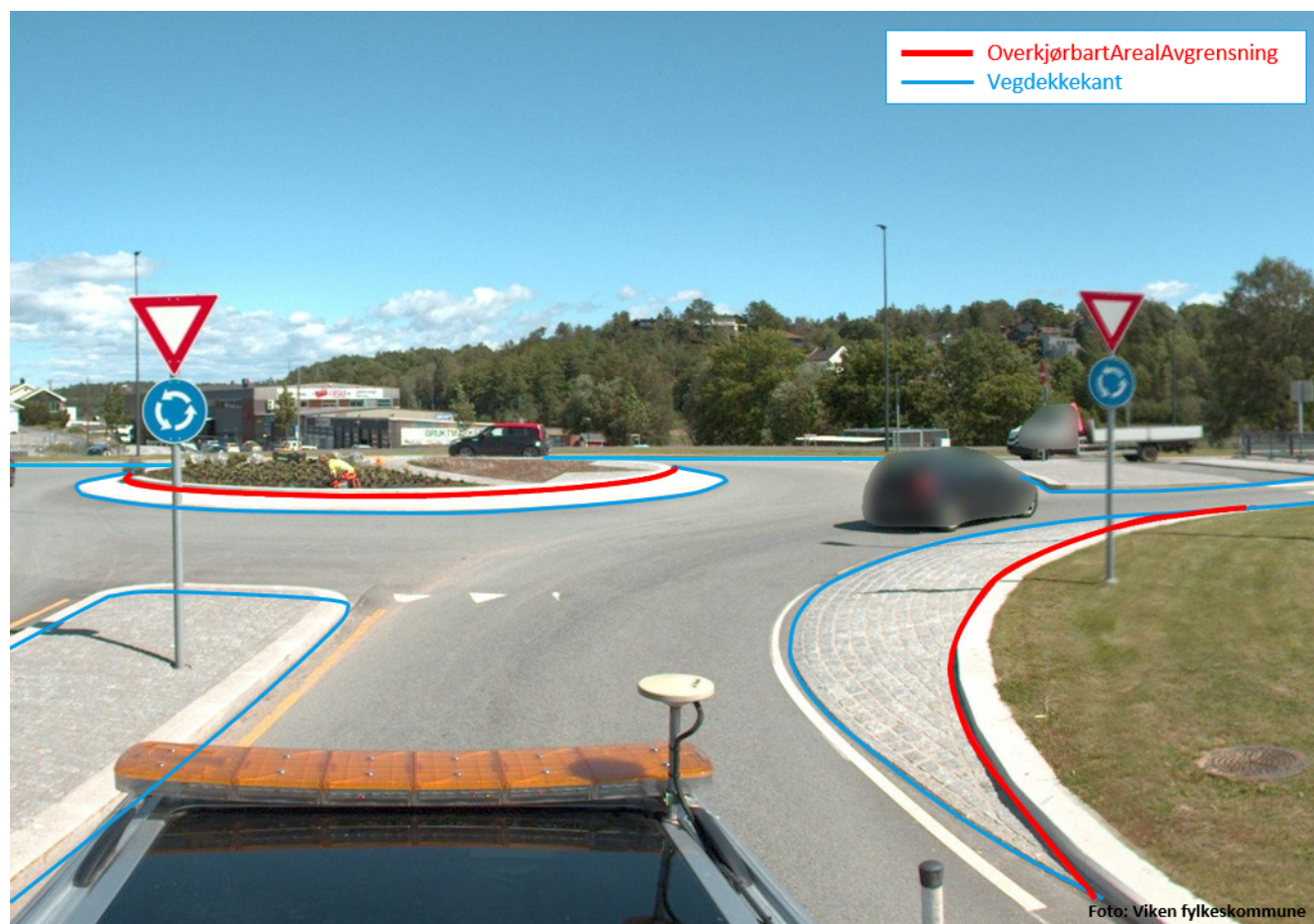
Figur 56. Eksempel på registrering av objekttype OverkjørbartArealAvgrensning. NB! Bildet er ikke dekkende for alle objekttyper og viser KUN Vegdekkekant og OverkjørbartArealAvgrensning
