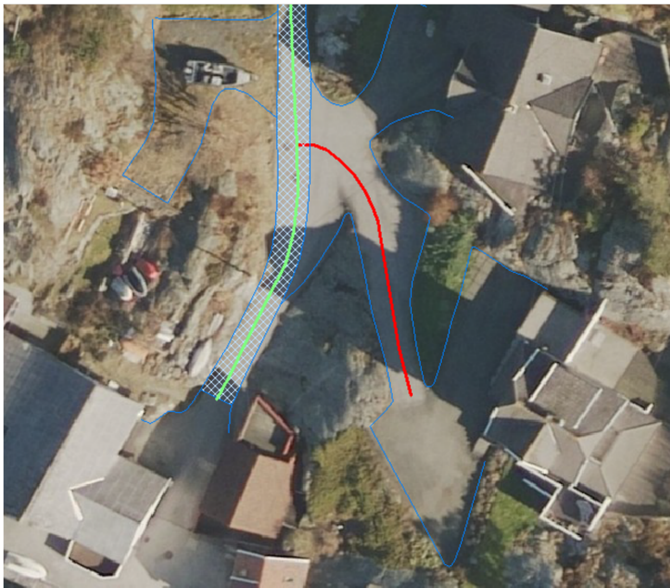
Figur 26. Eksempelet viser en Veglenke (rødt) i Elveg som er kortere enn 50 m som ikke skal slettes (selv om den ikke oppfyller kriteriene for fotogrammetrisk registrering) ettersom vegen fortsatt eksisterer og er kjørbær i bildene. I dette tilfellet skal det ikke registreres vegflate i FKB-Veg (inkonsistens mot Elveg tolereres).
