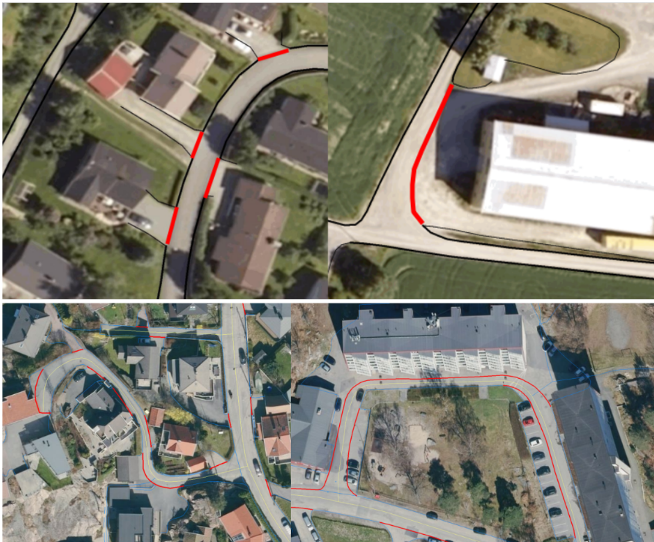
Figur 28. Eksempler på registrering av VegAnnenAvgrensning (tegnet med røde streker).
