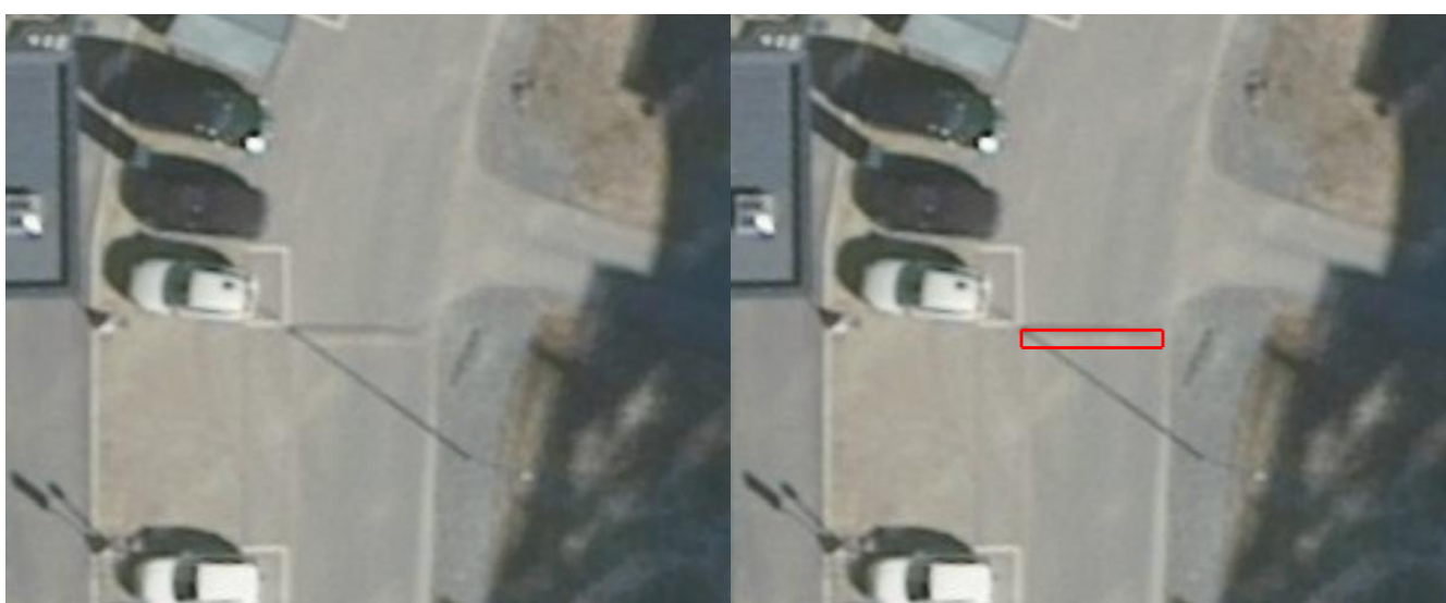
Figur 49. Eksempel på fartsdempere av "smal type" som skal registreres.
