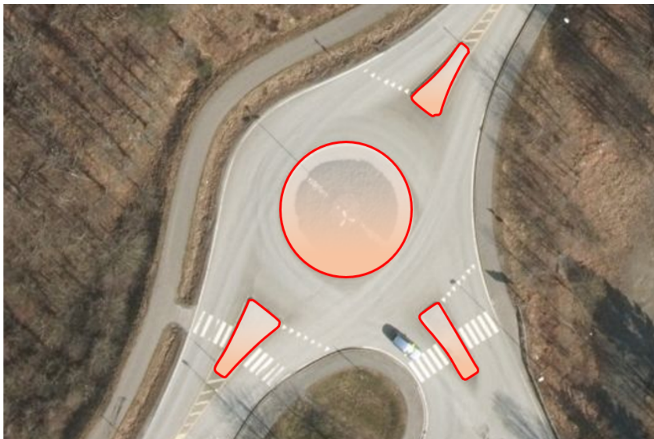
Figur 7. Illustrasjon fra produktspesifikasjon av Trafikkøy
