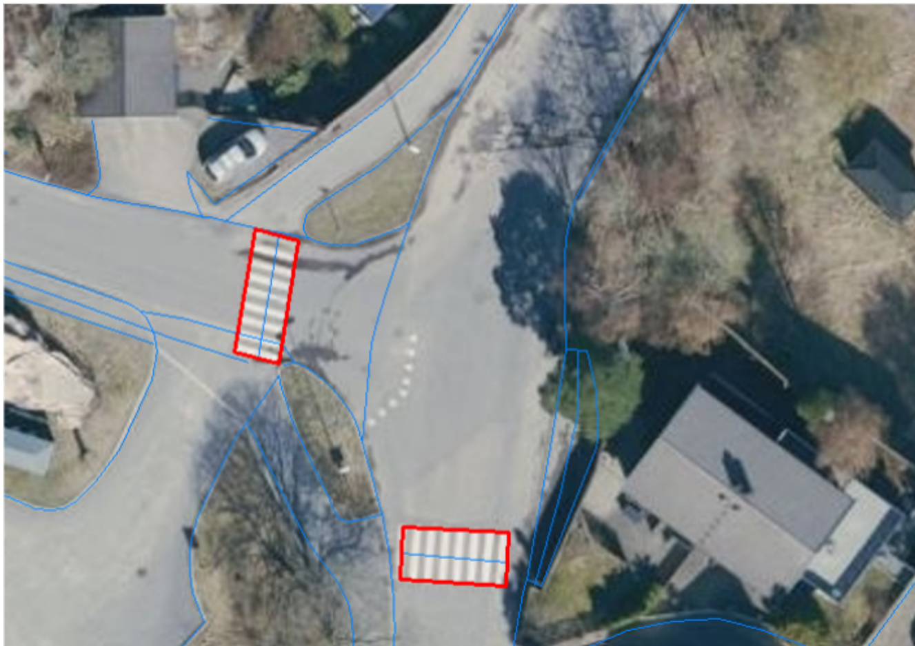
Figur 52. Eksempel på registrering av objekttype GangfeltAvgrensning (røde streker)
