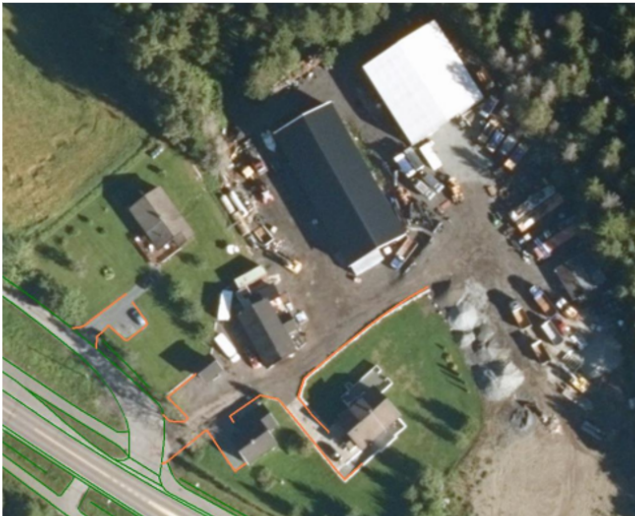
Figur 46. Eksempler på områder med tilstrekkelig registrering av AnnetVegarealAvgrensning (tegnet med oransje linjer)
